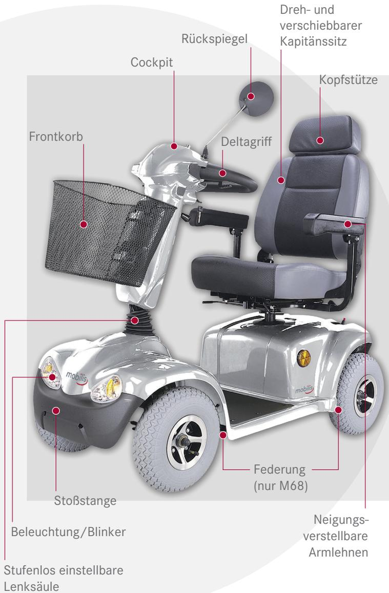
Stufenlos einstellbare Lenksäule
